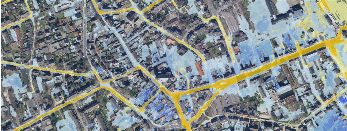
Modellierte Wassertiefen (blau) und Fließgeschwindigkeiten (gelb/orange) bei einem extremen Starkregen mit 90mm/h. Datenquelle BKG 2021
