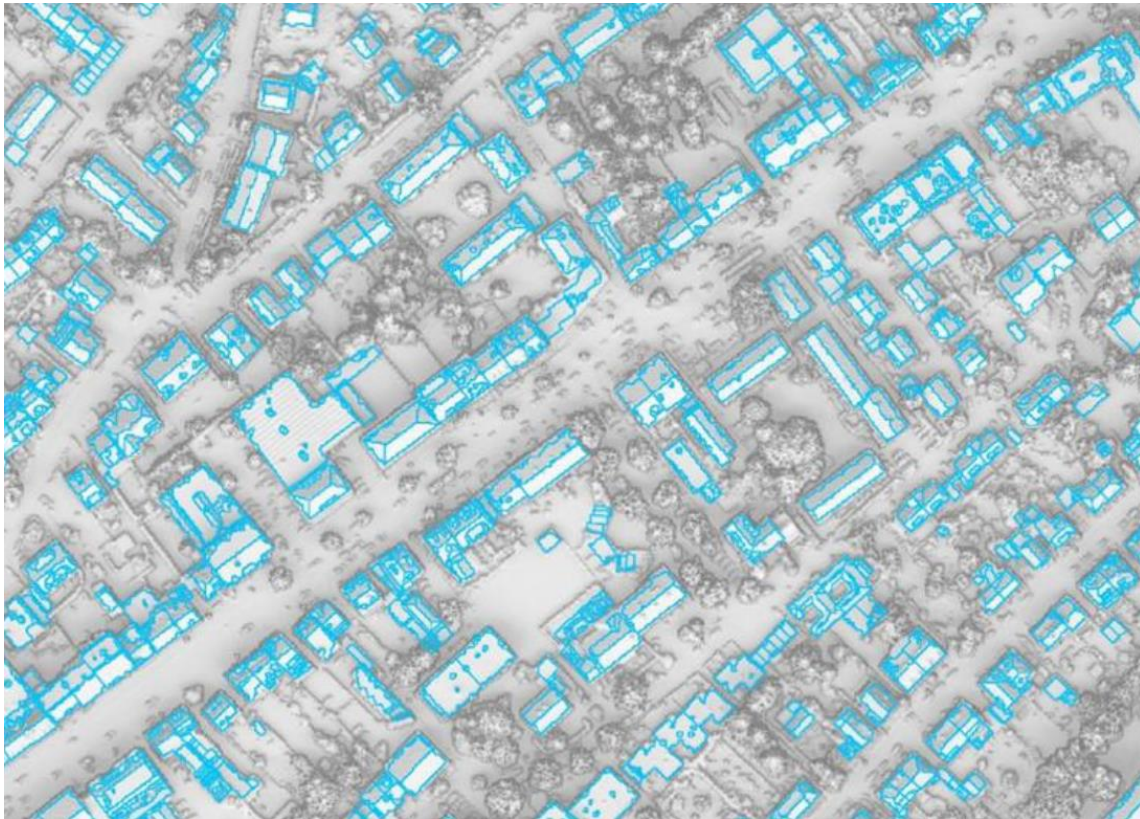
Abbildung 2: Beispiel Segmentierungsergebnis zur Dachflächenklassifikation (IP SYSCON 2020).
