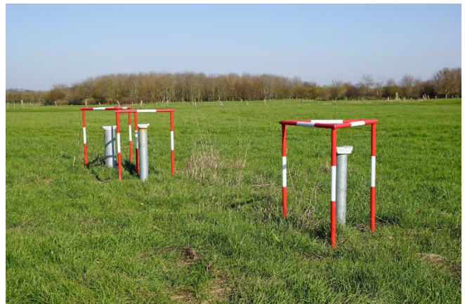
Grundwassermessstellen. Foto: brudertuck69/stock-adobe.com.
